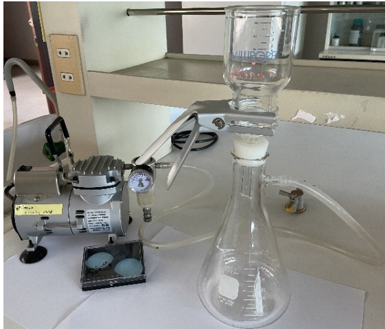
ภาพที่ 3.1 ชุดกรองตัวทำละลายหรือสารละลายเฟสเคลื่อนที่ (Mobile phase) สำหรับวิเคราะห์ด้วยเทคนิค HPLC
