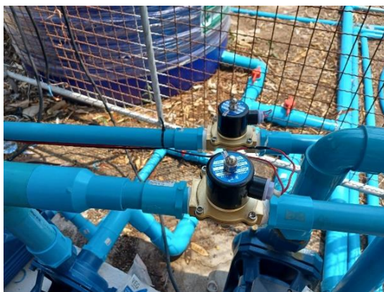
รูปที่ 3-5 ระบบควบคุมการให้น้ำในโรงเรือนอัจฉริยะสำหรับการปลูกกล้วยงเพื่อผลิตเมล็ดพันธุ์และเส้นใย
