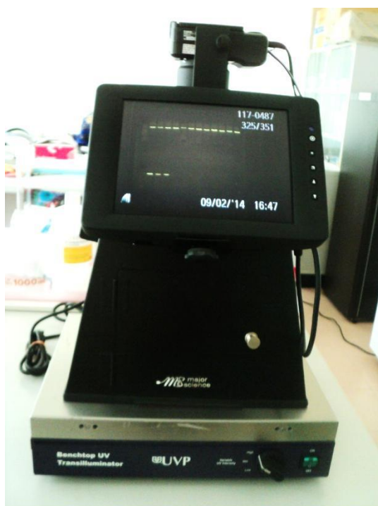
ภาพที่ ข2 ชุดเครื่องถ่ายภาพดีเอ็นเอ (UV Transilluminator, ยี่ห้อ UVP, รุ่น LLC Upland, cambridge, UK)
