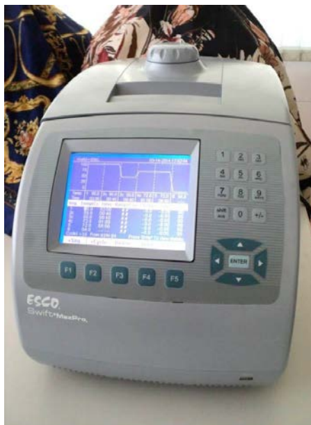
ภาพที่ ข1 เครื่องควบคุมปฏิกิริยาพีซีอาร์ (Swift™ MaxPro Thermal Cycler)
