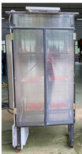
รูปที่ 3.7 การทดสอบเพื่อการศึกษาระยะเวลาใช้ในการอบพริกด้วยตู้อบแห้งพริกแบบพับเก็บได้
