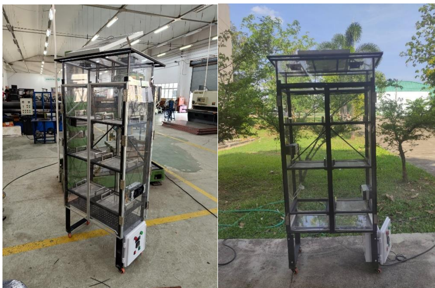
รูปที่ 3.2 ตู้อบพริกแห้งพริกแบบพับเก็บได้ต้นแบบที่พัฒนาขึ้นมา
