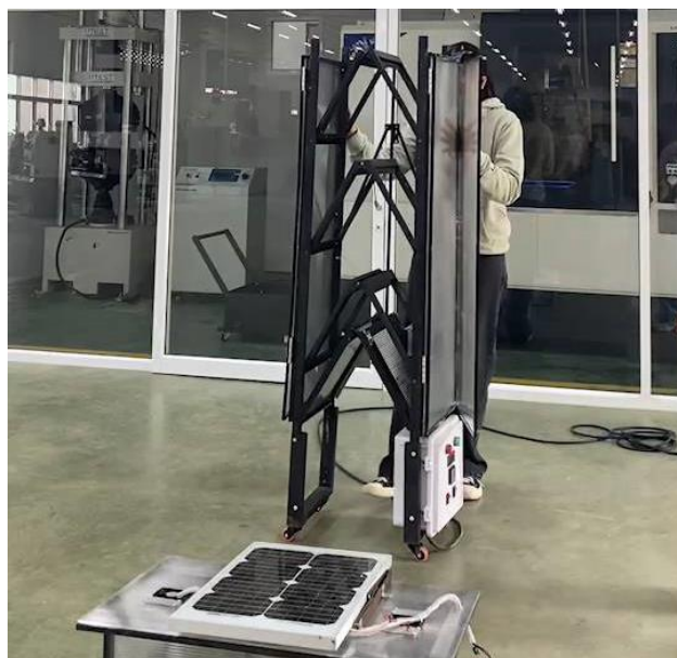
รูปที่ 4.2 ตู้อบพริกแห้งแบบพับเก็บได้ขณะทำการพับเก็บ
