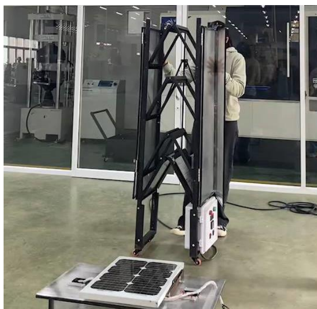
รูปที่ 3.3 ตู้อบพริกแห้งพริกแบบพับเก็บได้ขณะทำการพับเก็บ
