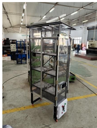
รูปที่ 4.1 ลักษณะของตู้อบพริกแห้งพริกแบบพับเก็บได้ต้นแบบ
