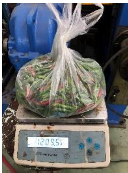
ภาพที่ ข-8 การทดลองครั้งที่ 8 ใช้ใบมีดที่ 2 เวลาที่ใช้ตัดก้านพริก 25 นาที ความเร็วมอเตอร์ 103 รอบต่อนาที
