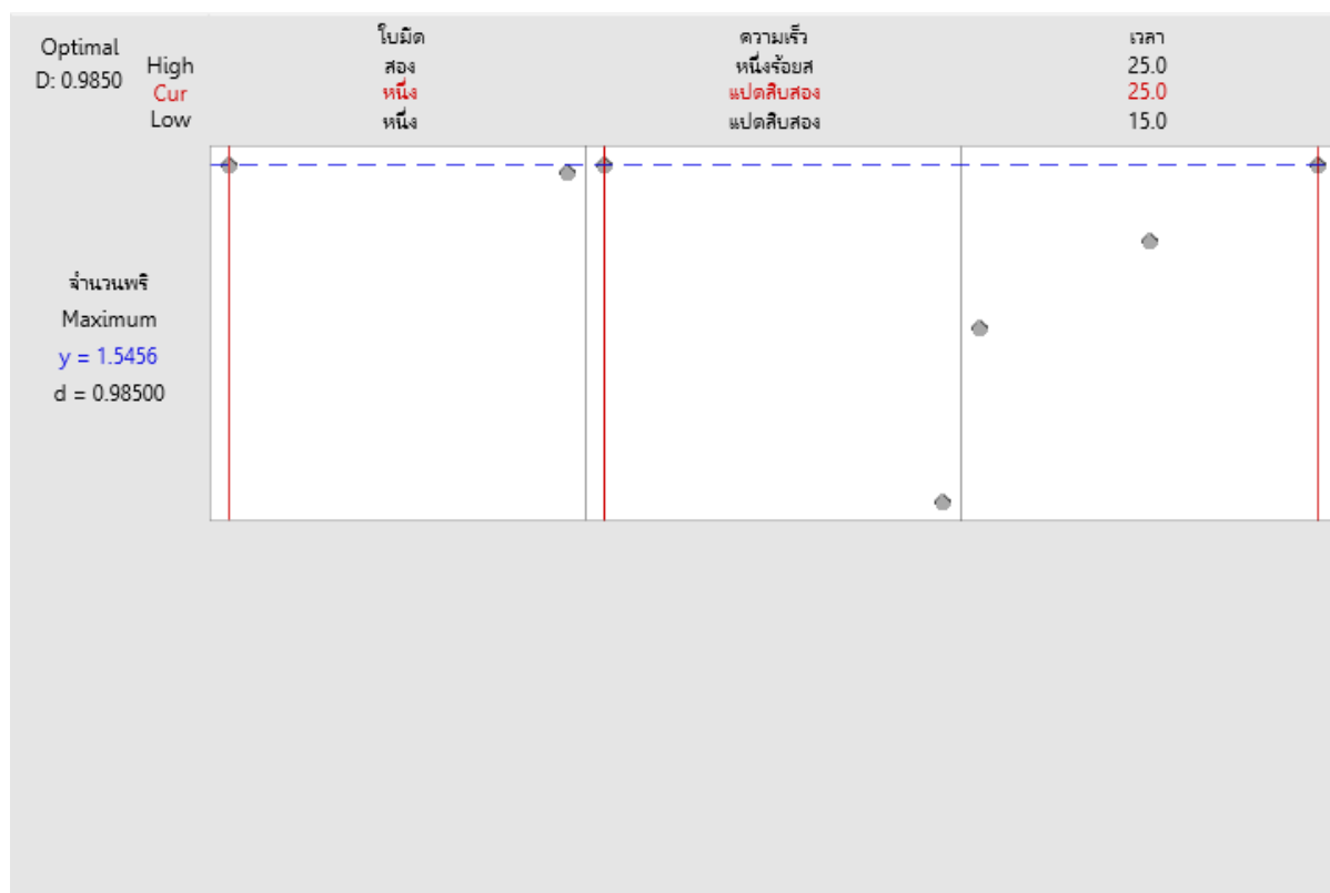
ภาพที่ 4-2 ค่าที่เหมาะสมในการปรับตั้งเครื่องตัดก้านพริก
