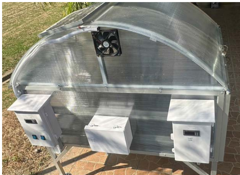
ภาพที่ 4-1 แสดงตัวเครื่องต้นแบบการอบจึงสำหรับควบคุมพารามิเตอร์ที่เหมาะสม
