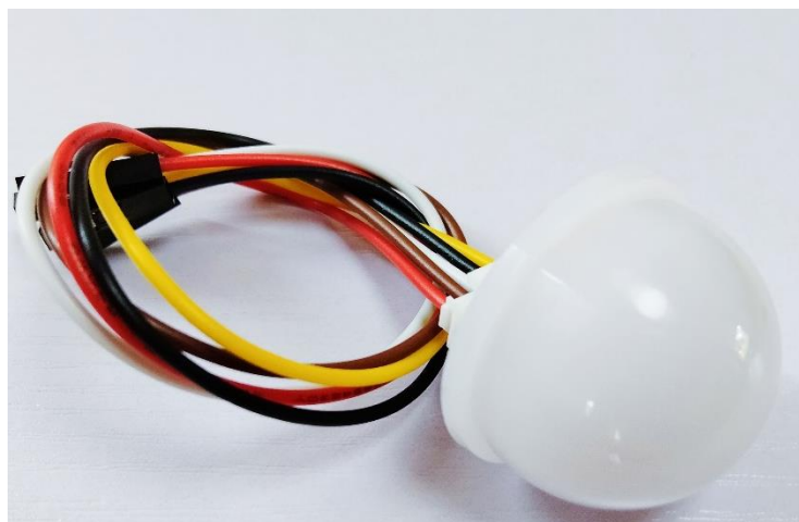
รูปที่ 2-24 เซนเซอร์วัดค่าแสงแบบใช้ทั้งภายในและภายนอกอาคาร
