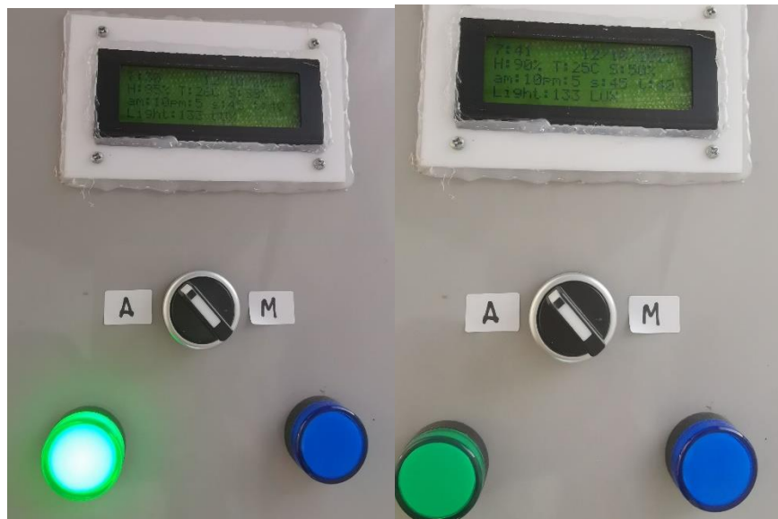
รูปที่ 3-16 การทดสอบการทำงานของระบบแบบอัตโนมัติในการรดน้ำเวลา 7.30 น.
