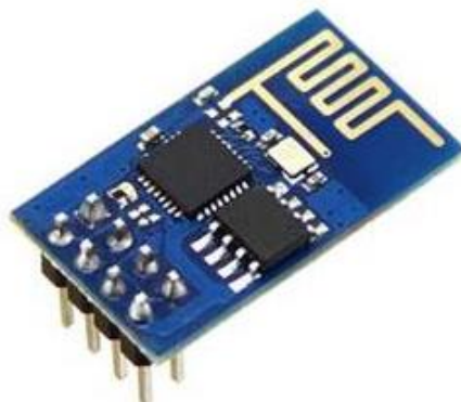
รูปที่ 2-17 โมดูล ESP8266 01 ผลิตโดยบริษัท Ai-Thinker หัวใจหลักคือไอซีESP8266
