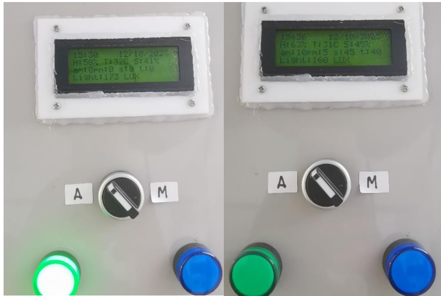
รูปที่ 3-17 การทดสอบการทำงานของระบบแบบอัตโนมัติในการรดน้ำเวลา 15.30 น.
