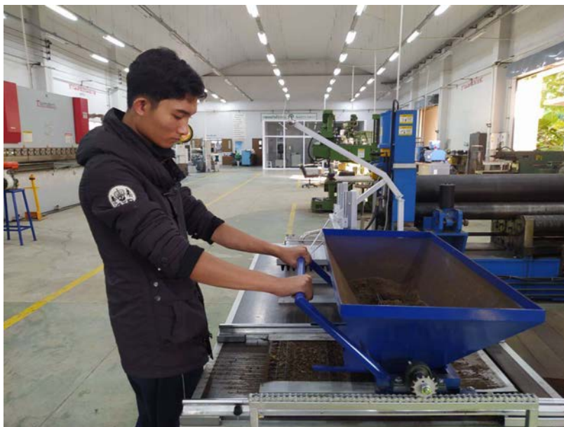
ภาพที่ 4.3 กรอกดินลงถาดเพาะกล้าขนาดถาด 200 หลุม
