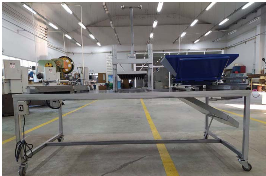
เครื่องรอกดินและหยอดเมล็ดพันธุ์พืชสำหรับถาดเพาะกล้า
