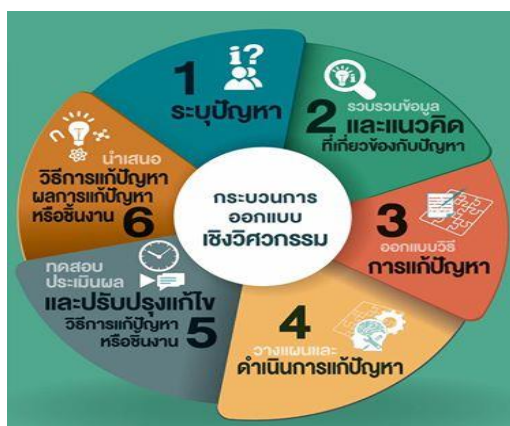
ภาพที่ 1 กระบวนการออกแบบเชิงวิศวกรรม (Engineering Design Process ) สถาบันส่งเสริมการสอนวิทยาศาสตร์และเทคโนโลยี,2557)
