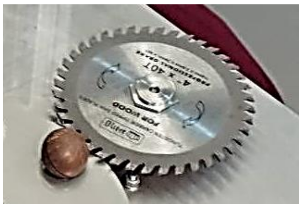
ภาพที่ 3.7 การสร้างชุดใบมีดตัดผลแมคคาเดเมีย
