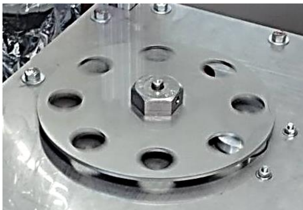
ภาพที่ 3.6 การสร้างชุดลูกกลิ้งดันแมคคาเดเมีย
