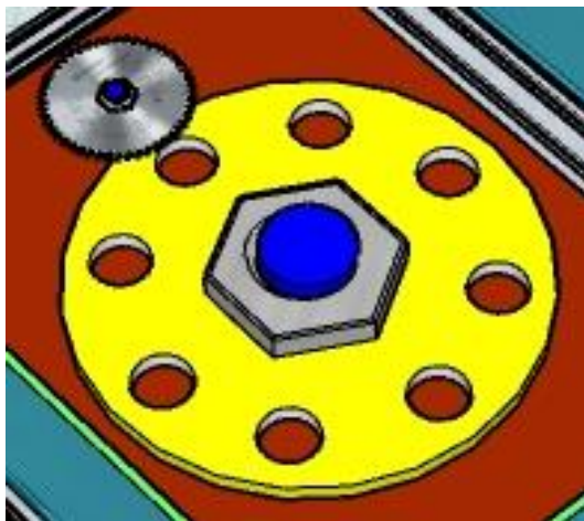
ภาพที่ 3.4 การออกแบบชุดจับยึดแมคคาเดเมีย
