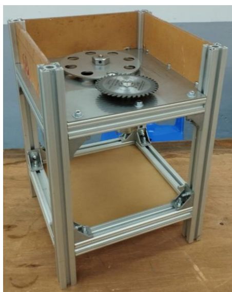
ภาพที่ 3.9 การประกอบเทคโนโลยีเครื่องกรีดกะลาแมคคาเดเมียแบบกึ่งอัตโนมัติ
