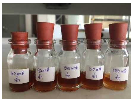
รูปที่ ผก 13 ไบโอดีเซลที่ได้จากตัวแปรเวลา
