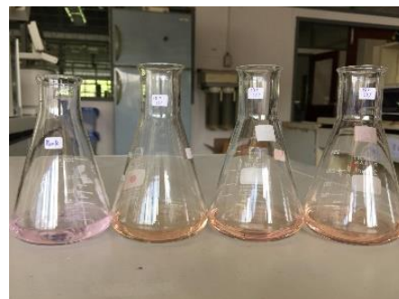
รูปที่ ผก 14 การวิเคราะห์หา %FFA
