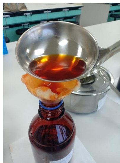
รูปที่ 3-3 การกรองสารสกัดสมุนไพร โดยกรองผ่านผ้าก๊อชและกระดาษกรอง Whatman No.1 (ที่มา:คณะผู้วิจัย, 2021)
