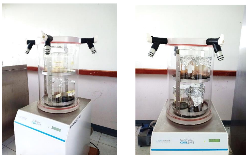
รูปที่ 3-5 การระเหยแห้งสารสกัดโดยใช้เครื่องระเหยแห้ง (Freeze dryer) (ที่มา:คณะผู้วิจัย, 2021)
