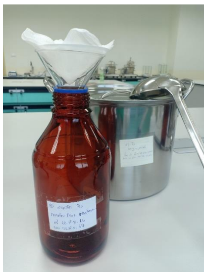
รูปที่ 3-3 การกรองสารสกัดสมุนไพร โดยกรองผ่านผ้าก๊อชและกระดาษกรอง Whatman No.1 (ที่มา:คณะผู้วิจัย, 2021)
