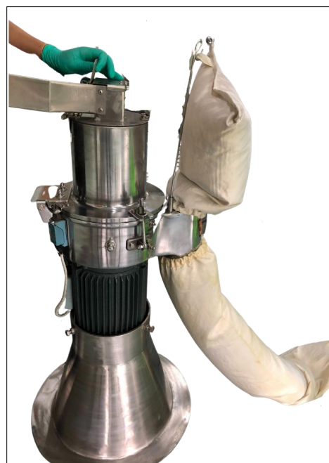
รูปที่ 3-2 การบดสมุนไพรโดยใช้เครื่องบดสมุนไพรแบบละเอียด (ที่มา:คณะผู้วิจัย, 2021)
