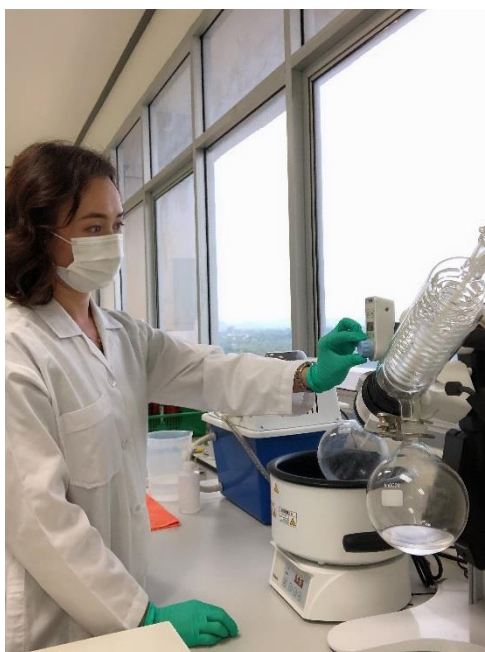
แยกตัวทำละลาย (95% เอทานอล) ออกจากสารสกัดโดยใช้เครื่องระเหยสุญญากาศ Rotary evaporator
