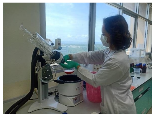
รูปที่ 3-4 การระเหยตัวทำละลายโดยใช้เครื่องระเหยตัวทำละลายสุญญากาศ (Rotary evaporator) (ที่มา:คณะผู้วิจัย, 2021)
