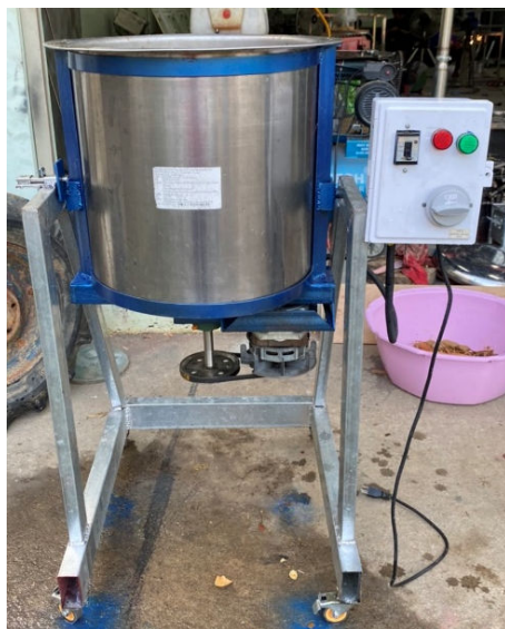
รูปที่ ก 1 ภาพถ่ายด้านหน้าของเครื่องปอกเปลือกมะขามแช่อิ่ม
