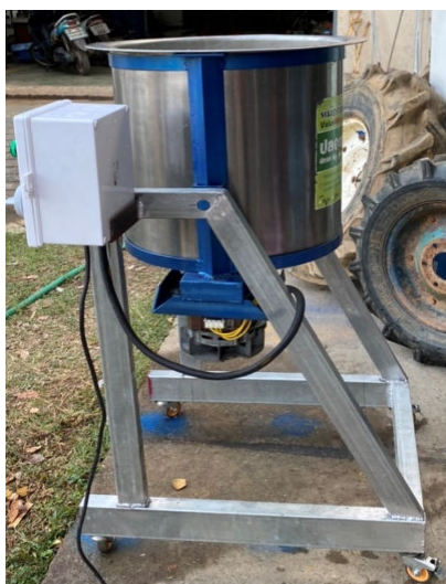
รูปที่ ก 3 ภาพถ่ายด้านข้างของเครื่องปอกเปลือกมะขามแช่อิ่ม
