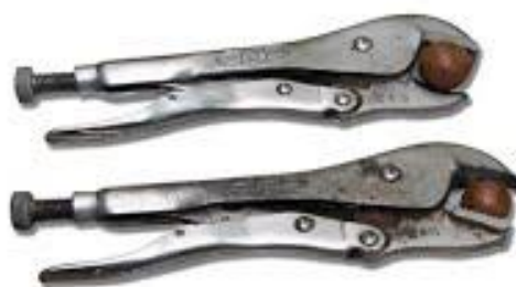
ภาพที่ 2.3 เครื่องกะเทาะแบบคีมล็อก ที่มา สุวัฒน์ กาใจ, 2563, 6 ธันวาคม
