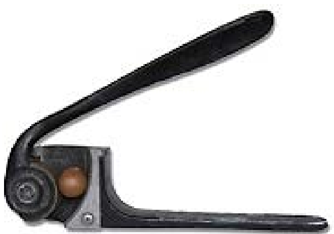
ภาพที่ 2.5 เครื่องกะเทาะแบบร่อนฟันกดอัด ที่มา สุวัฒน์ กาใจ, 2563, 6 ธันวาคม
