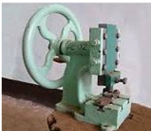
ภาพที่ 2.6 เครื่องกะเทาะแบบใบมีดกระแทก ที่มา สุวัฒน์ กาใจ, 2563, 6 ธันวาคม
