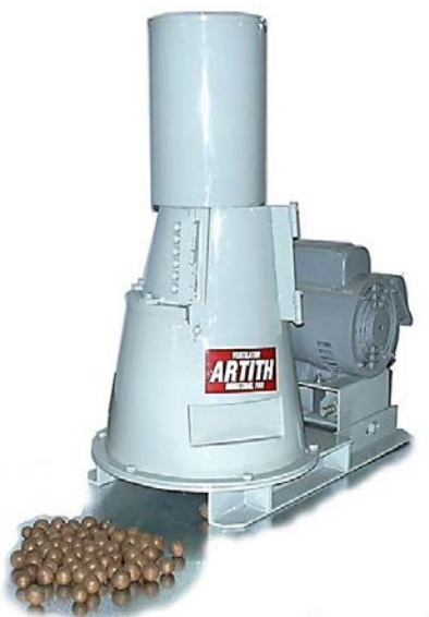
ภาพที่ 2.7 เครื่องกะเทาะเมล็ดแมคคาเดเมีย ที่มา ARTITH VENTILATORS and ARTITH MACHINERY, ม.ป.ป.
