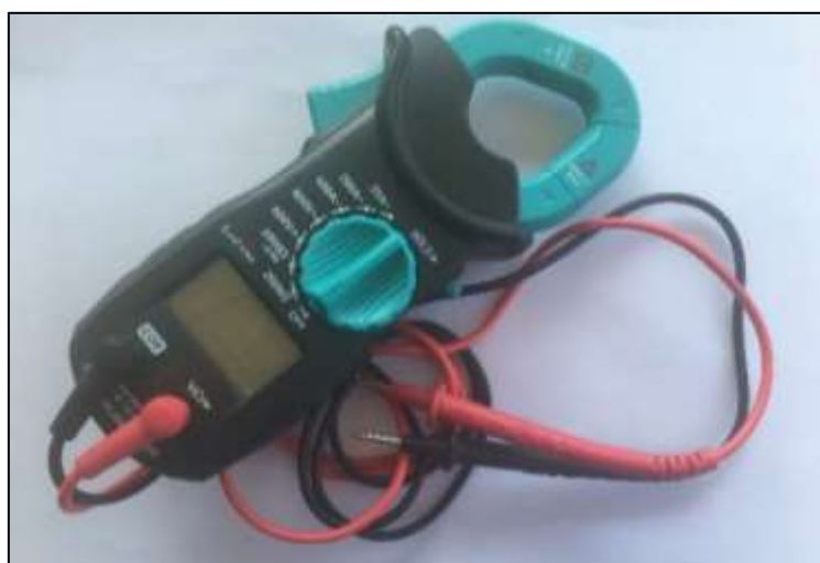
รูปที่ 3.13 เครื่องมือวัดกระแสไฟฟ้ามาตรฐานมัลติมิเตอร์ LuZino รุ่น 7000728
