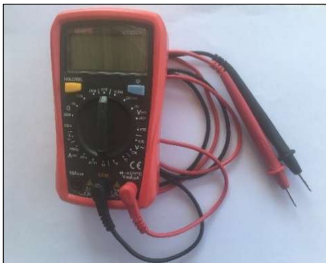
รูปที่ 3.12 เครื่องมือวัดแรงดันไฟฟ้ามาตรฐานมัลติมิเตอร์ UNI-T รุ่น UT33C+
