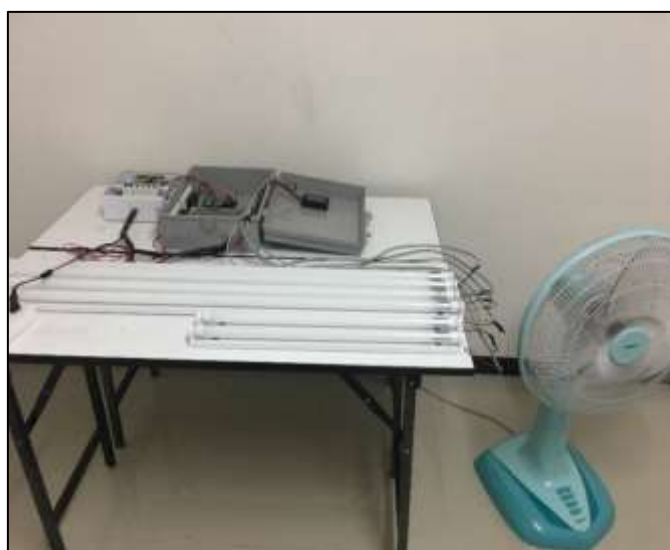
รูปที่ 3.6 โหลดในการทดสอบระบบควบคุมไฟฟ้าโดยรวมสำหรับบ้านอัจฉริยะเพื่อผู้สูงอายุ
