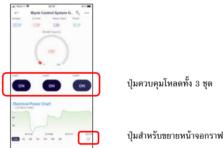
รูปที่ 4.2 หน้าจอเฝ้ามองระบบไฟฟ้าและควบคุมโหลดบนมือถือ
