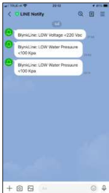
รูปที่ 4.6 ตัวอย่างการแจ้งเตือนแรงดันไฟฟ้าและแรงดันน้ำต่ำกว่าค่าที่กำหนดบนมือถือผ่านไลน์แอปพลิเคชัน
