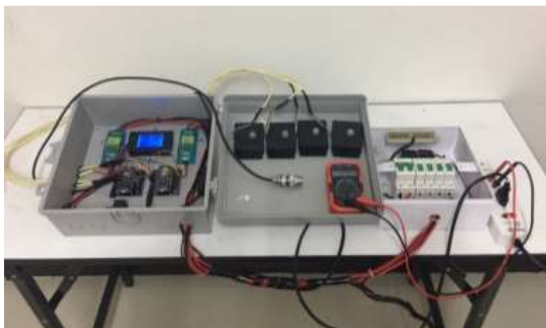
รูปที่ 4.4 ระบบเฝ้ามองสาธารณูปโภคและแจ้งเตือนความปลอดภัยภายในบ้านสำหรับผู้สูงอายุ
