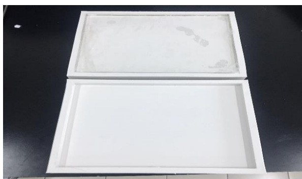
ภาพที่ 3.12 บล็อกหล่อเรซินที่ทำจากการหล่อซิลิโคน
