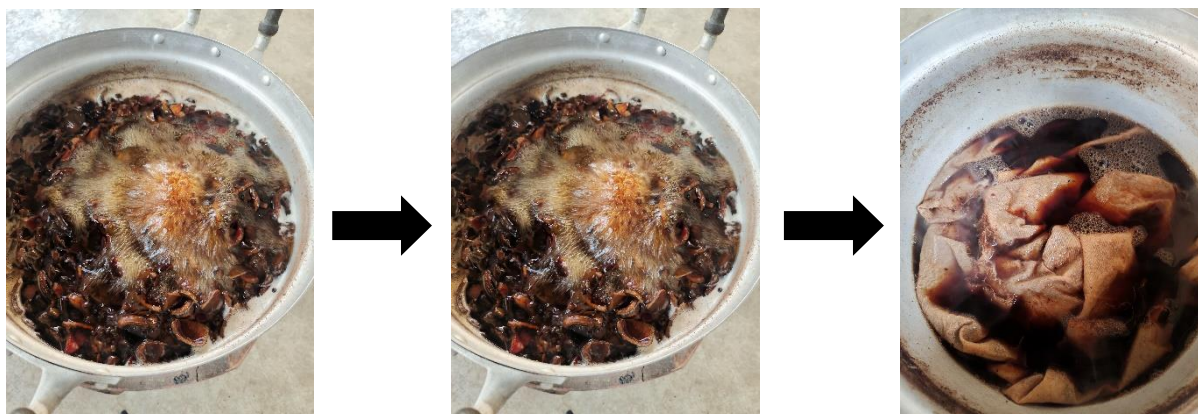
ภาพที่ 4.4 การสกัดสีย้อมจากเปลือกกะลาแมคคาเดเมีย
