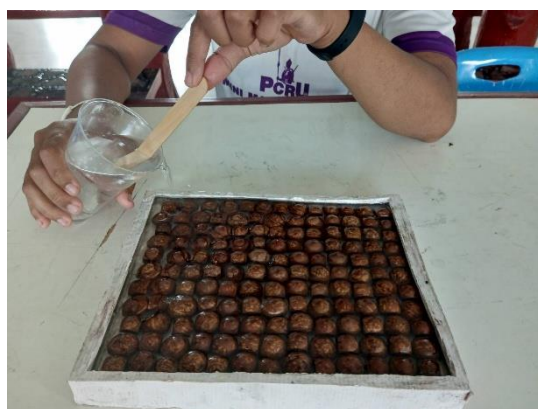
ภาพที่ 3.16 เทน้ำยาเรซินรอบที่สองลงในบล็อกซิลิโคนที่เตรียมไว้
