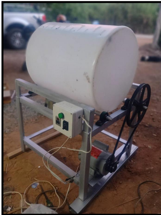
ภาพที่ 4-1 เครื่องคลุกฟุ้งแช่บ๊วย
