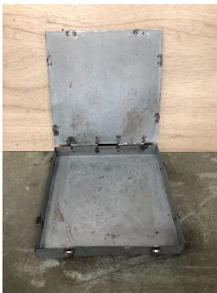
รูปที่ ก-5 แม่พิมพ์หล่อวัสดุ ขนาด 35x35x5 cm
