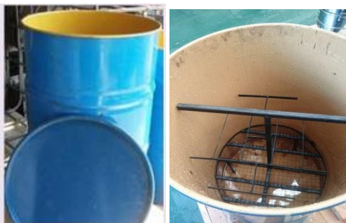
รูปที่ 3.3 หม้อนึ่งจากถังน้ำมันขนาด 200 ลิตร
