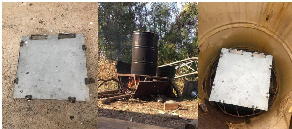
รูปที่ ก-29 แม่พิมพ์สำหรับขึ้นรูปเบาะรองนั่งที่ปิดฝาแล้ว ไปนั่งในหม้อนึ่งไอน้ำ
