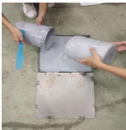
รูปที่ ก-27 เทฟองน้ำยางลงในแม่พิมพ์สำหรับขึ้นรูป
