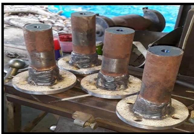
ภาพที่ 3-4 แสดงภาพเพลายึดไว้ยึดหัวเจาะและระบบเฟือง
