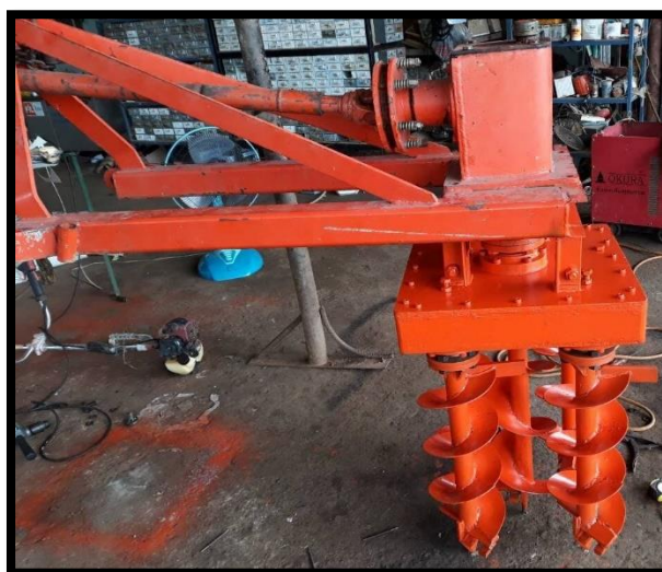
ภาพที่ 3-10 แสดงภาพที่นำชุด 5 หัวเจาะมาประกอบตัวขับเคลื่อนรถไถ
