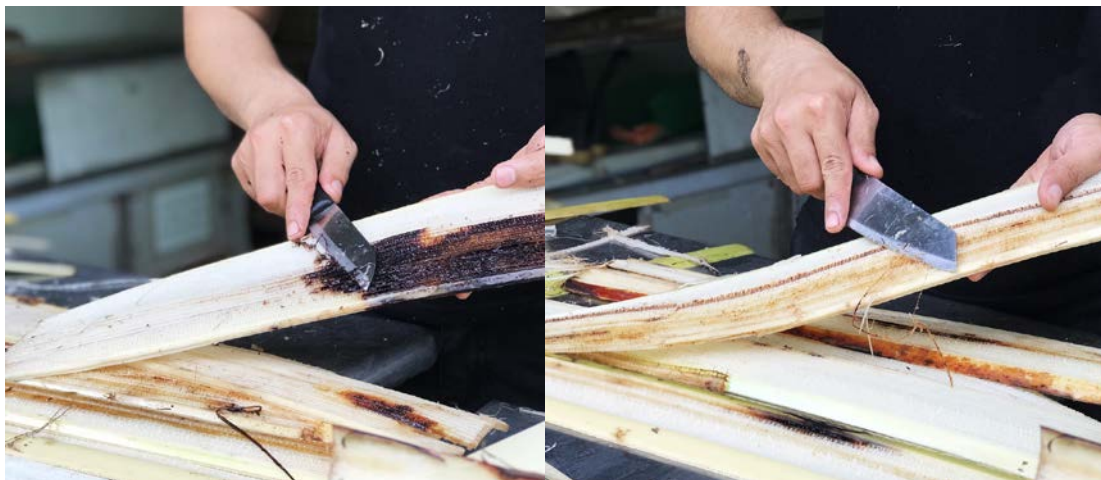
รูปที่ 3-5 การขูดเยื่อกากกล้วย
