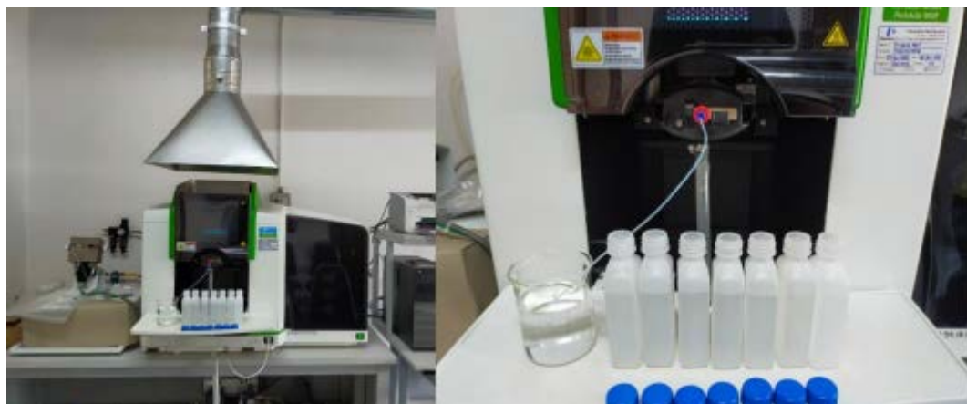
ภาพที่ 9 การวิเคราะห์หาปริมาณโพแทสเซียม (K)
