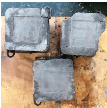
รูปที่ 3.1 แบบหล่อลูกบาศก์คอนกรีตขนาด 10 x 10 x 10 เซนติเมตร
