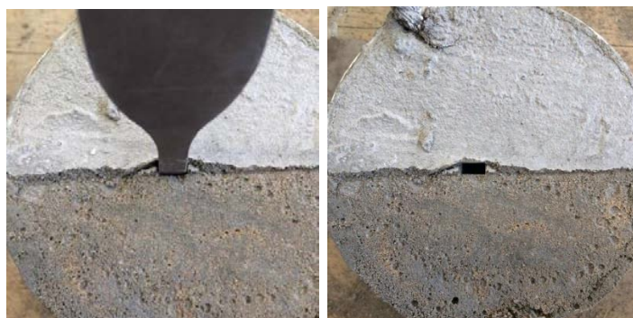
รูปที่ 4.10 การหลุดตัวของคอนกรีตออกจากผิวของยางชั้นยึดติดที่ใช้เถ้าลอยเป็นสารตัวเติม
