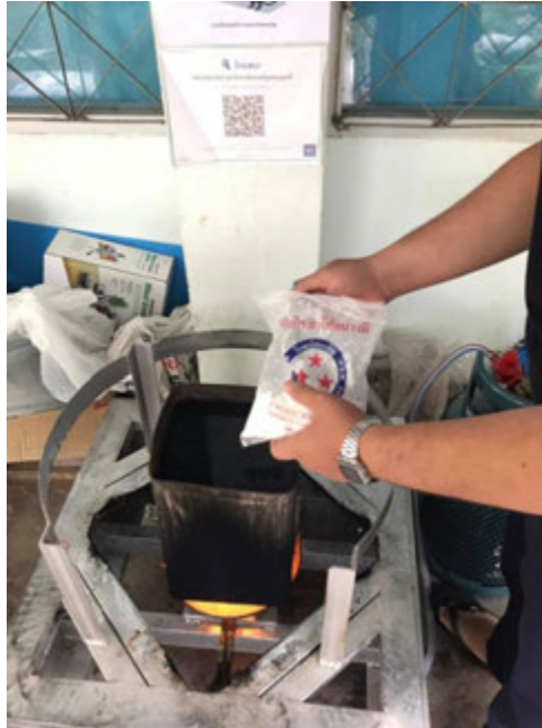
ภาพที่ 3-12 แสดงการล้างผ้าด้วยโซดาไฟ ที่มา: น้ำฝน เบ้าทองคำ
