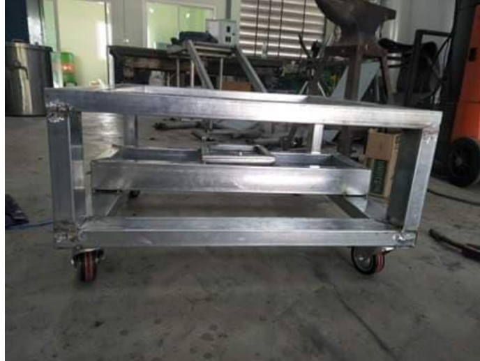
ภาพที่ 3-5 แสดงรูปแบบฐานวางตัวเครื่องย้อมผ้า ที่มา: น้ำฝน เบ้าทองคำ
