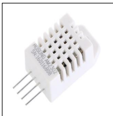
ภาพที่ 2.14 เซ็นเซอร์สำหรับวัดอุณหภูมิและความชื้นสัมพัทธ์ DHT22
