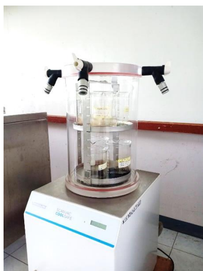
รูปที่ 3-5 การระเหิดแห้งสารสกัดโดยใช้เครื่องระเหิดแห้ง (Freeze dryer) (ที่มา:คณะผู้วิจัย, 2021)
