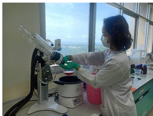
รูปที่ 3-4 การระเหิดตัวทำละลายโดยใช้เครื่องระเหิดตัวทำละลายสุญญากาศ (Rotary evaporator) (ที่มา:คณะผู้วิจัย, 2021)
