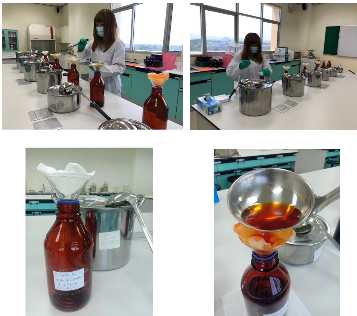
รูปที่ 3-3 การกรองสารสกัดสมุนไพร โดยกรองผ่านผ้าก๊อชและกระดาษกรอง Whatman No.1 (ที่มา:คณะผู้วิจัย, 2021)
