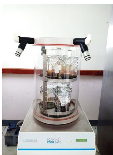
รูปที่ 3-5 การระเหิดแห้งสารสกัดโดยใช้เครื่องระเหิดแห้ง (Freeze dryer) (ที่มา:คณะผู้วิจัย, 2021)
