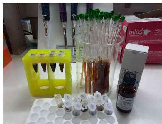
รูปที่ 3-7 การเตรียมสารตัวอย่างสำหรับการทดสอบด้วยเทคนิค nuclear magnetic resonance spectroscopy (NMR) (ที่มา:คณะผู้วิจัย, 2021)
