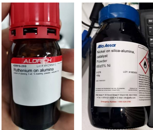
รูปที่ 3.1 ตัวเร่ง \text{Ru}/\text{Al}_2\text{O}_3 และ \text{Ni}/\text{SiO}_2\text{-Al}_2\text{O}_3 สำหรับเร่งปฏิกิริยาในปฏิกรณ์พลาสมา
