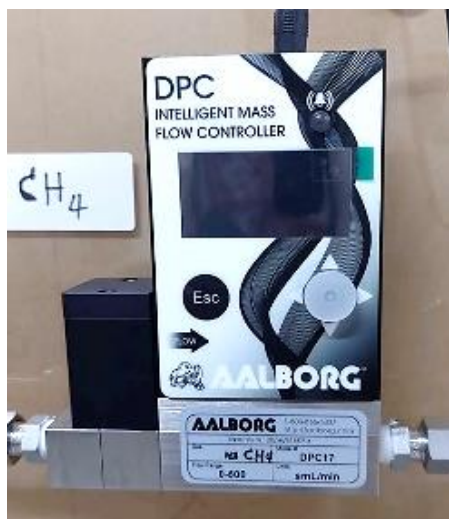
รูปที่ 3.9 ตัวควบคุมอัตราการไหลแบบดิจิทัลยี่ห้อ Aalborg รุ่น DPC17S-VOL6-AA3
