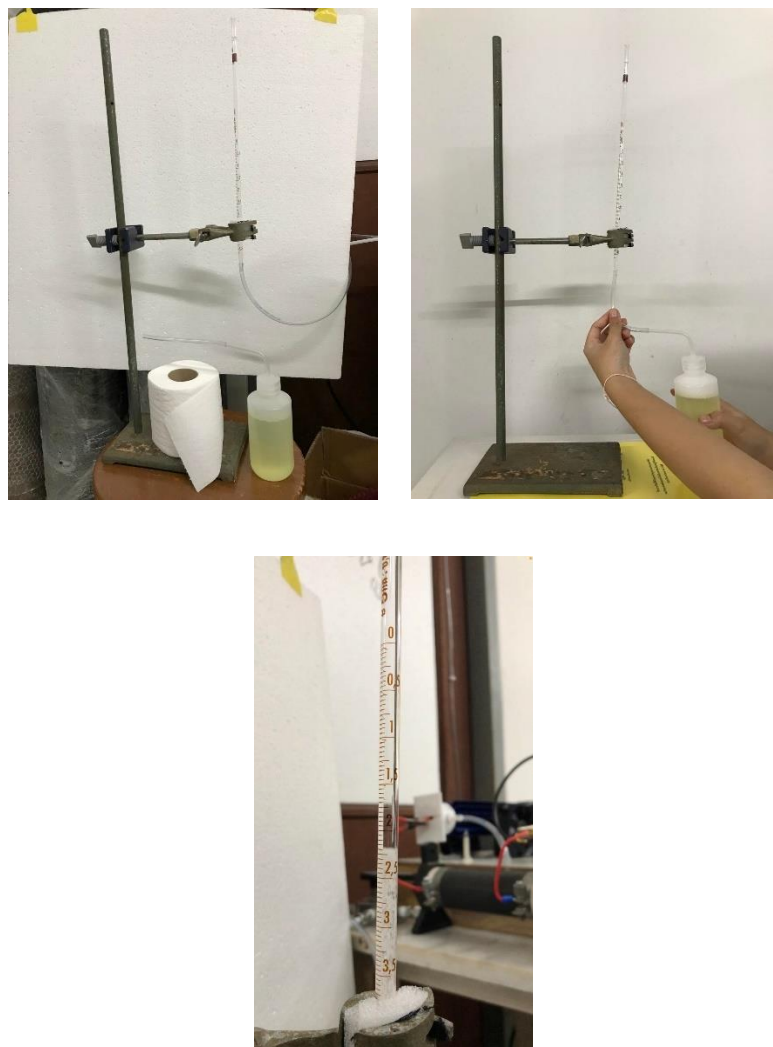
รูปที่ ข.1 ตรวจสอบอัตราการไหลของระบบด้วยปิเปต
