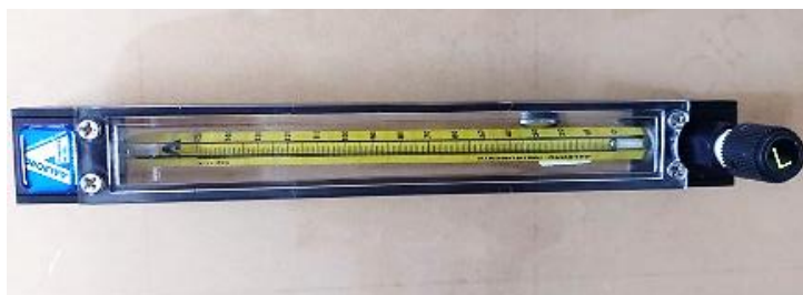
รูปที่ 3.8 อุปกรณ์ควบคุมอัตราการไหลแบบลูกลอยยี่ห้อ Aalborg รุ่น Influx Flow Tubes
