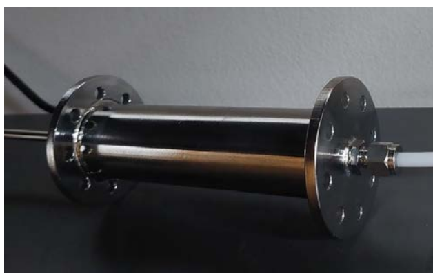
รูปที่ ก.3 ท่อผสมก๊าซ (Mixer unit)
