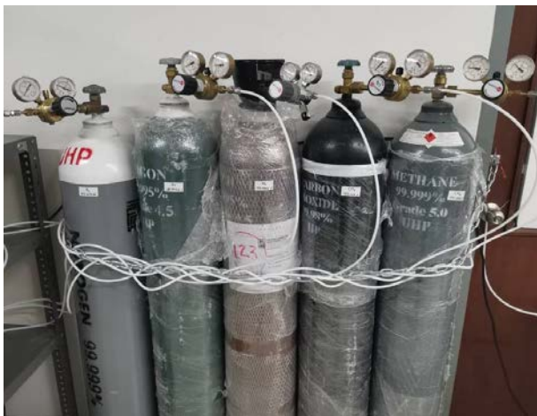
รูปที่ ก.1 ก๊าซสำหรับป้อนเข้าสู่ระบบพลาสมาที่มีการติดตั้งเกจวัดแรงดันและวาล์วระบายแรงดัน
