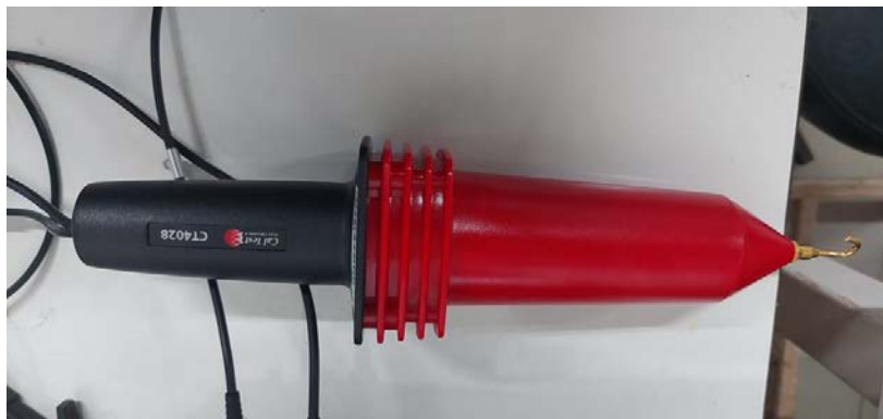
รูปที่ 3.6 โพรบวัดไฟฟ้าแรงดันสูงยี่ห้อ Cal Test รุ่น CT4028
