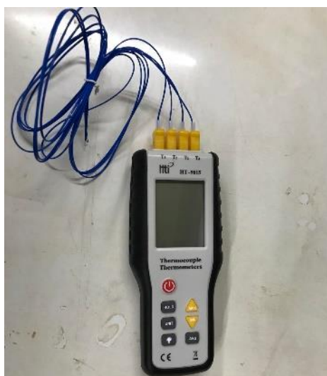
รูปที่ 3.10 เทอร์โมมิเตอร์แบบเทอร์โมคัปเปิล รุ่น HT-9815
