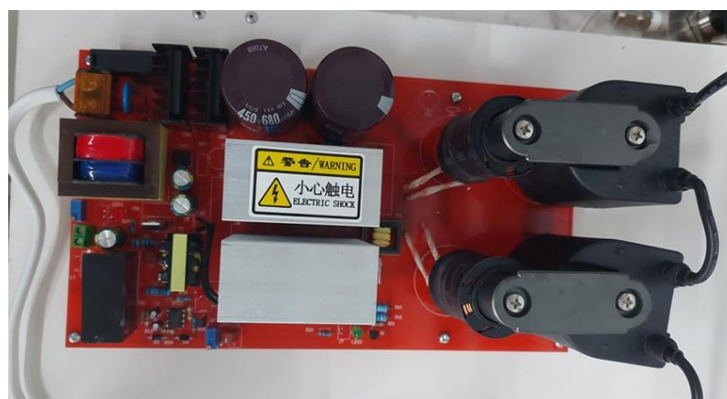
รูปที่ 3.4 แหล่งจ่ายไฟฟ้าแรงดันสูง
