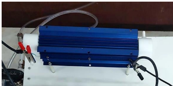
รูปที่ 3.15 ลักษณะทางกายภาพภายนอกของปฏิกรณ์สำหรับกำเนิดพลาสมา
