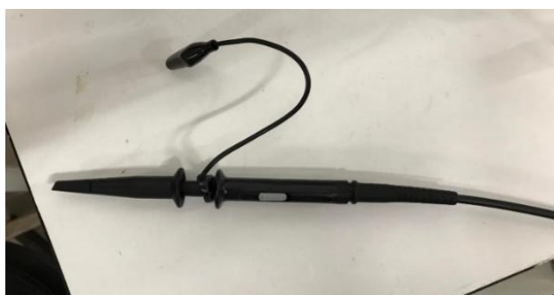
รูปที่ 3.7 โพรบวัดไฟฟ้าแรงดันต่ำที่มาพร้อมออสซิลโลสโคป
