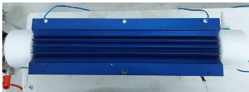
รูปที่ 3.3 ปฏิกิริยาเครื่องกำเนิดพลาสมาแบบไดอิเล็กทริกแบริเออร์ดิสชาร์จ
