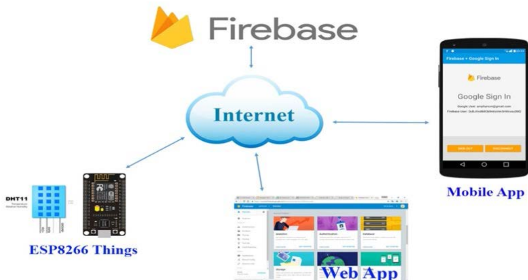
ภาพที่ 2-20 รูปแบบการทำงานของ Firebase Real-time Database ที่มา (Chen, et al., June 2019)
