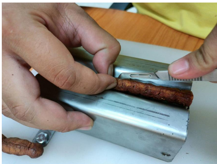
ภาพที่ 4.2 ลักษณะคุณภาพรอยกรีดฝักมะขามด้วยตัวจับยึดสำหรับการกรีดเนื้อมะขามหวาน
