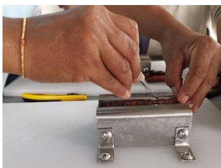
ภาพที่ 3.8 การทดลองใช้ตัวจับยึดสำหรับการกรีดเนื้อมะขามหวาน
