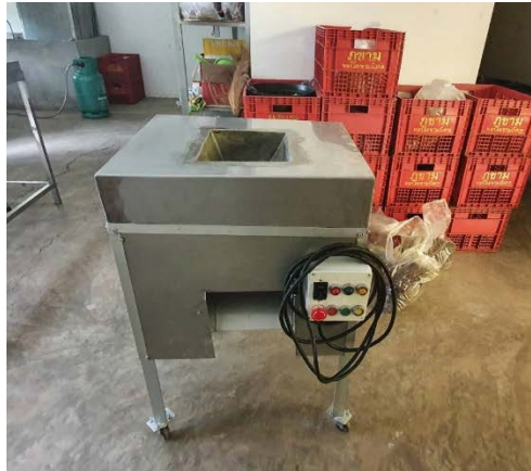
ภาพที่ 18 เครื่องทำมะขามจี๊ดจ๊าดต้นแบบ
