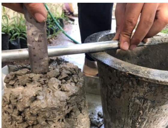
ภาพที่ 3.11 ทดสอบหาค่ายุบตัวของคอนกรีต Slump Test
