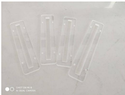
ภาพที่ 3.8 แผ่นอะคลิลิกที่ตัดด้วยเครื่อง CNC แล้ว
