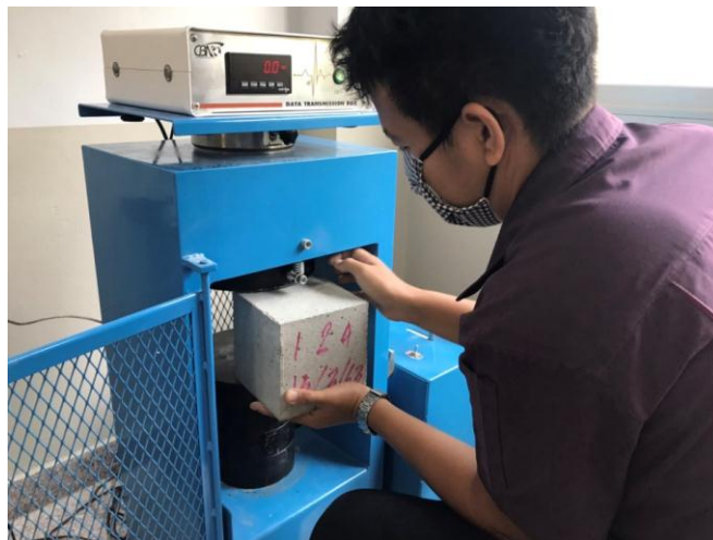
ภาพที่ 3.15 นำลูกปูนเข้าเครื่องทดสอบ Compressive Machine
