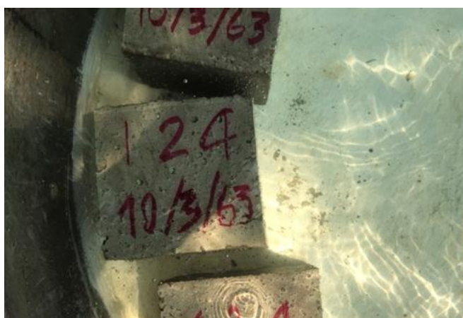
ภาพที่ 3.14 การบ่มลูกปูนทดสอบด้วยน้ำ ที่มีค่าความเข้มข้นของสนามแม่เหล็กที่แตกต่างกัน
