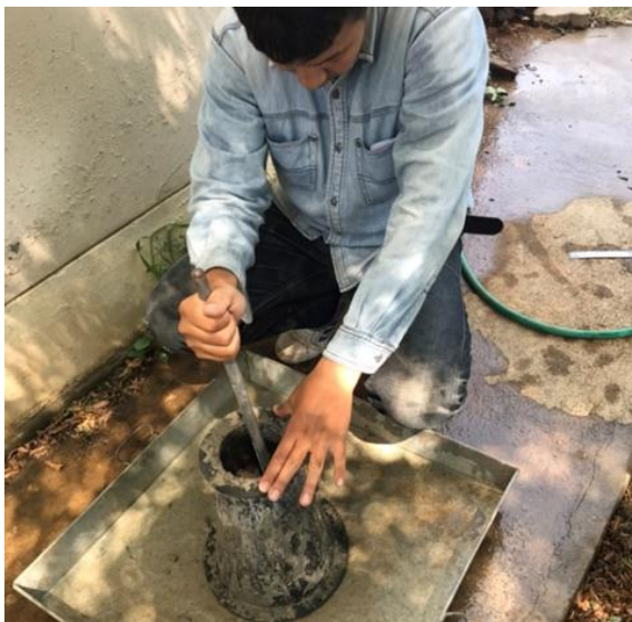
ภาพที่ 3.10 ทดสอบหาค่ายุบตัวของคอนกรีต Slump Test
