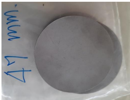
รูปที่ 4.18 สแตนเลสพูนแผ่นกลมเส้นผ่านศูนย์กลาง 47.0 mm สำหรับใช้เป็นแผ่นรองเมมเบรนขณะทดสอบ
