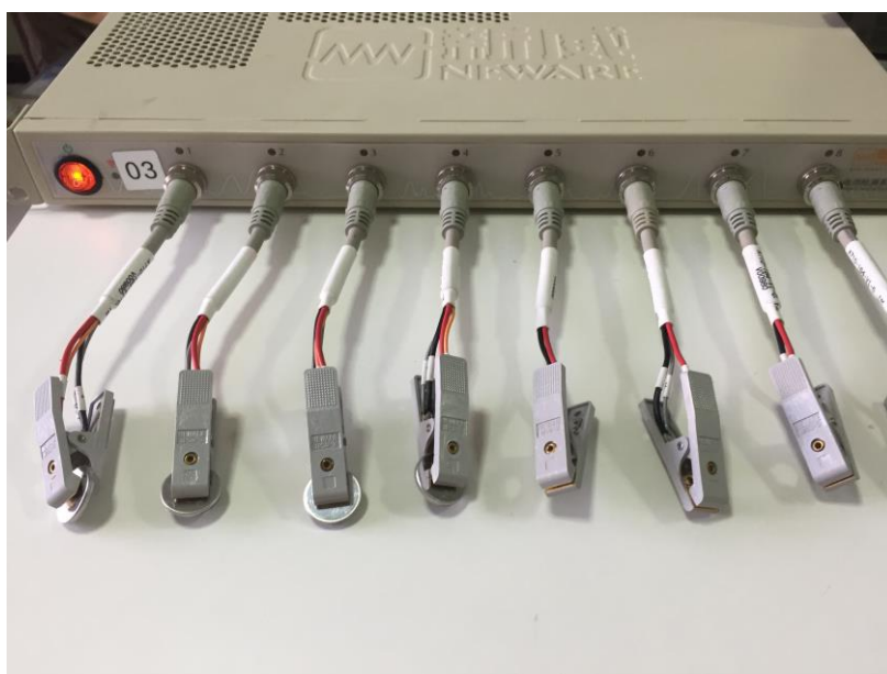
รูปที่ 3-13 การวัดประสิทธิภาพของตัวเก็บประจุยิ่งยวดด้วยเครื่อง Battery Testers system
