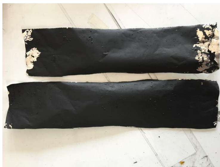
รูปที่ 3-4 ขี้ไฟฟ้าจากนาโนคาร์บอนบนแผ่นอะลูมิเนียมฟอยล์
