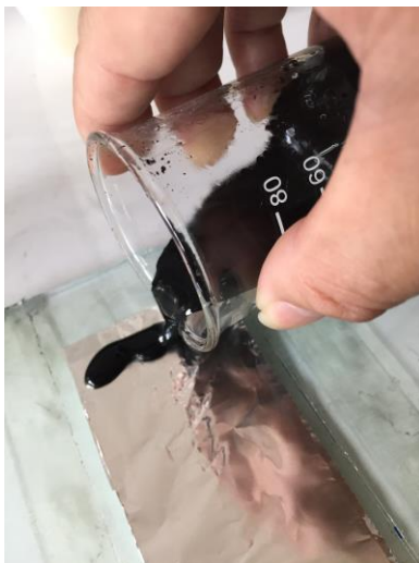
รูปที่ 3-3 การเตรียมฟิล์มนาโนคาร์บอนบนแผ่นอะลูมิเนียมฟอยล์
