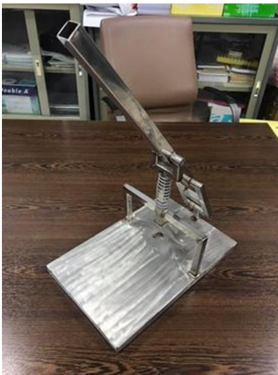
ภาพที่ 3.6 ภาพเครื่องขึ้นรูปก้อนมะขามเปรี้ยวปรุงรสต้นแบบ
