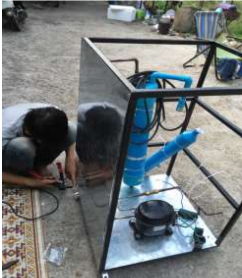
ภาพที่ 3.14 ประกอบสังกะสีเรียบเข้ากับโครงสร้าง
