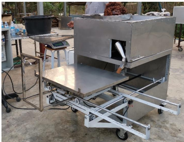
ภาพที่ 3.2 ต้นแบบเครื่องแปรรูปมะขามอัดแท่งแบบชุดรองรับควบคุมได้ สำหรับกลุ่มวิสาหกิจชุมชน กลุ่มดวงทอง จังหวัดเพชรบูรณ์
