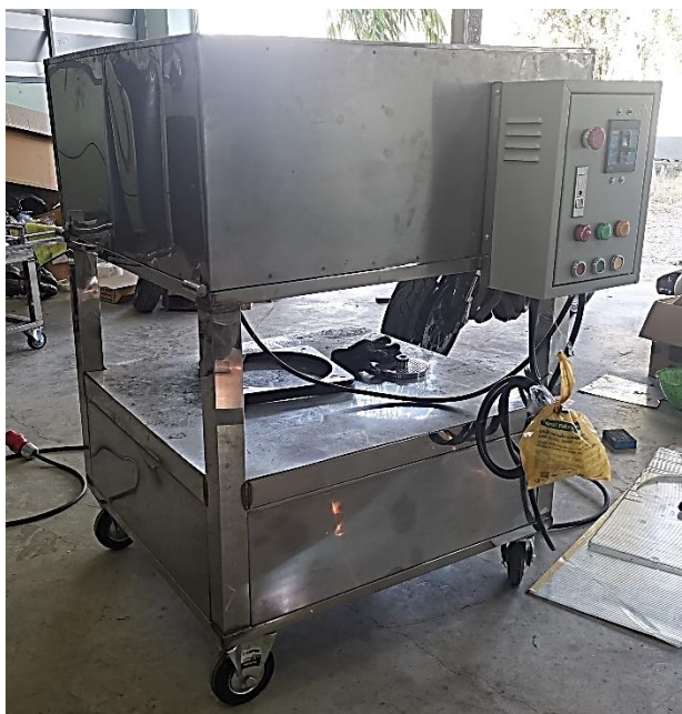
ภาพที่ 3.6 ต้นแบบเครื่องแปรรูปมะขามอัดแท่งแบบชุดรองรับควบคุมได้ สำหรับกลุ่มวิสาหกิจชุมชนกลุ่มดวงทอง จังหวัดเพชรบูรณ์
