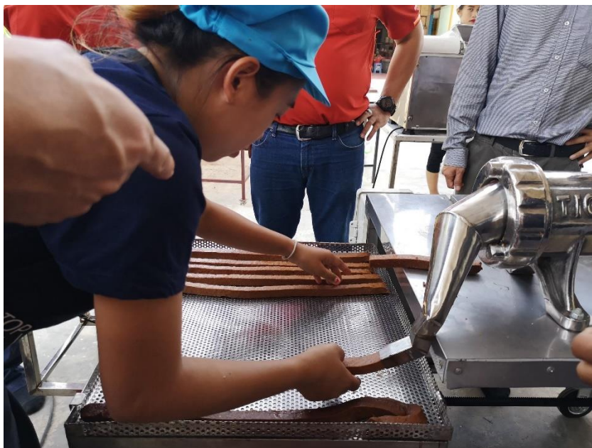
ภาพที่ 3.3 การทดลองใช้ต้นแบบเครื่องแปรรูปมะขามอัดแท่งแบบชุดรองรับควบคุมได้ สำหรับกลุ่มวิสาหกิจชุมชนกลุ่มดวงทอง จังหวัดเพชรบูรณ์ แบบอัดแท่งสี่เหลี่ยม
