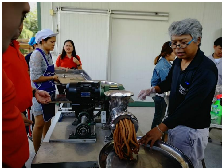
ภาพที่ 3.4 การทดลองใช้ต้นแบบเครื่องแปรรูปมะขามอัดแท่งแบบชุดรองรับควบคุมได้ สำหรับกลุ่มวิสาหกิจชุมชนกลุ่มดวงทอง จังหวัดเพชรบูรณ์ แบบอัดแท่งกลม
