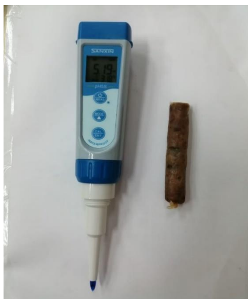
รูปที่ ค.4 แสดงลักษณะของเครื่องทดสอบค่า pH และตัวอย่างไส้กรอกเห็ดเสริมเมล็ดมะขาม
