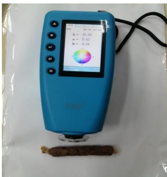
รูปที่ ค.2 แสดงลักษณะหน้าจอของเครื่องทดสอบค่าสี และตัวอย่างไส้กรอกเห็ดเสริมเมล็ดมะขาม
