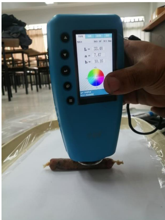
รูปที่ ค.1 แสดงการทดสอบค่าสีของตัวอย่างไส้กรอกเห็ดเสริมเมล็ดมะขาม
