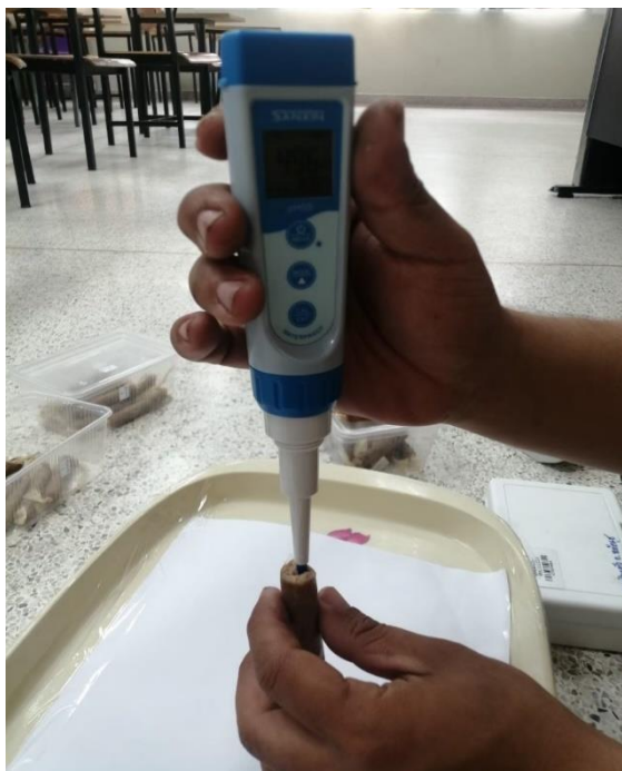
รูปที่ ค.3 แสดงการทดสอบค่า pH ของตัวอย่างไส้กรอกเห็ดเสริมเมล็ดมะขาม
