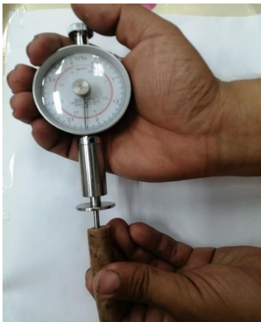
รูปที่ ค.5 แสดงการทดสอบค่าความแน่นเนื้อของตัวอย่างไม้กรอกเห็ดเสริมเมล็ดมะขาม
