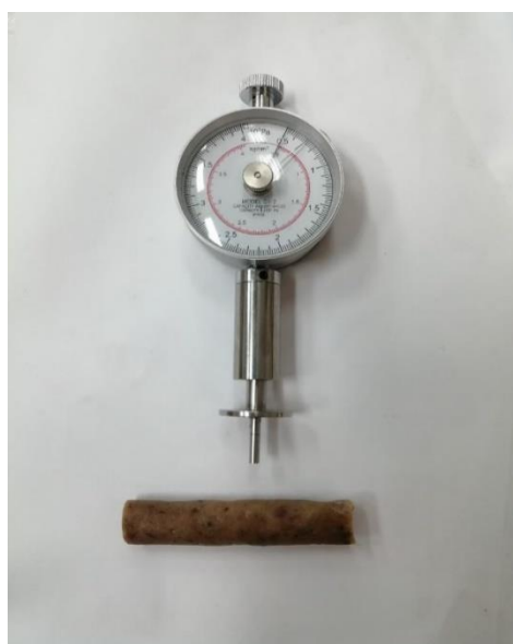
รูปที่ ค.6 แสดงลักษณะของเครื่องทดสอบค่าความแน่นเนื้อ และและตัวอย่างไม้กรอกเห็ดเสริม เมล็ดมะขาม
