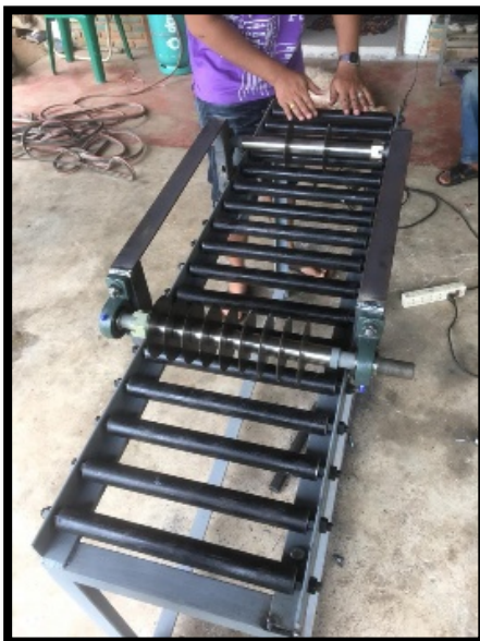
ภาพที่ 4-19 แสดงรูปโครงสร้างที่ใส่ชุดใบมีดและที่วางเลื่อน
