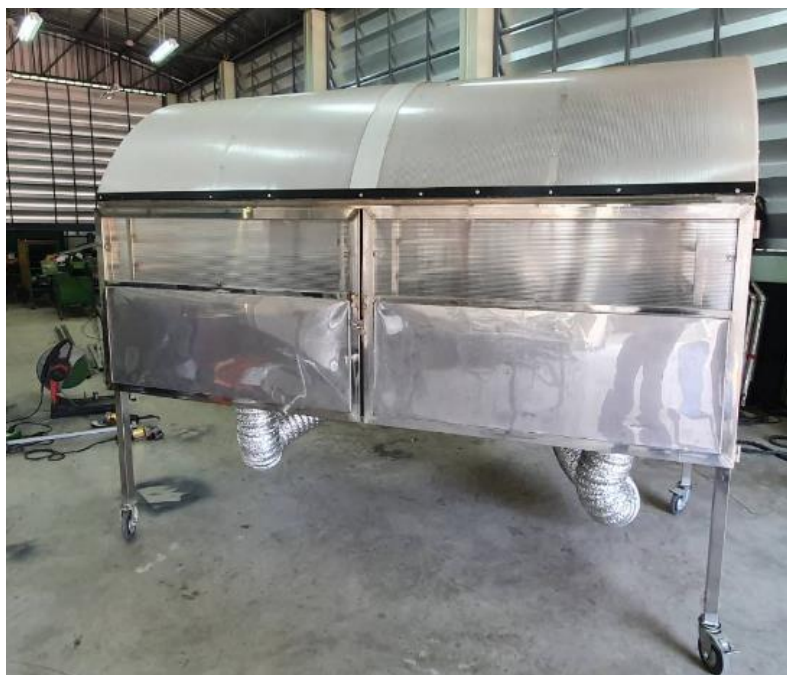
ภาพตู้ควบคุมป้อนกลับแบบปิด
