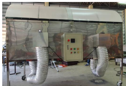
รูปที่ 4-2 ระบบการควบคุมพัดลมระบายอากาศและแผงควบคุมความร้อนแบบควบคุมป้อนกลับ
