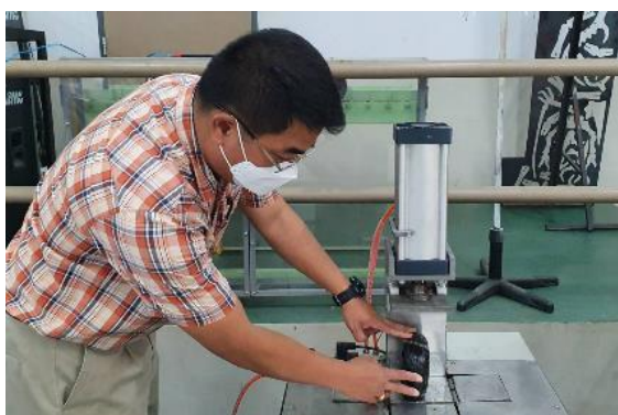
ขั้นตอนที่ 3 : นำชิ้นงานที่เตรียมไว้ใส่ลงบนเพลทอัด
