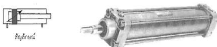
รูปที่ 2-29 แสดงกระบอกสูบสองทางแบบมีตัวกันกระแทก
