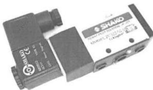
รูปที่ 2-21 แสดงวาล์ว 3/2 ปกติปิด เลื่อนด้วยขดลวดโซลินอยด์ เลื่อนกลับด้วยสปริง
