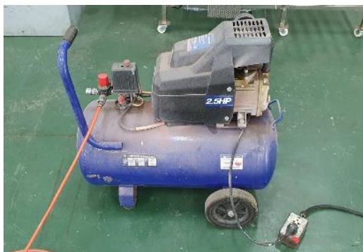
ขั้นตอนที่ 1 : ติดตั้งปั๊มลมกับเครื่องจักร
