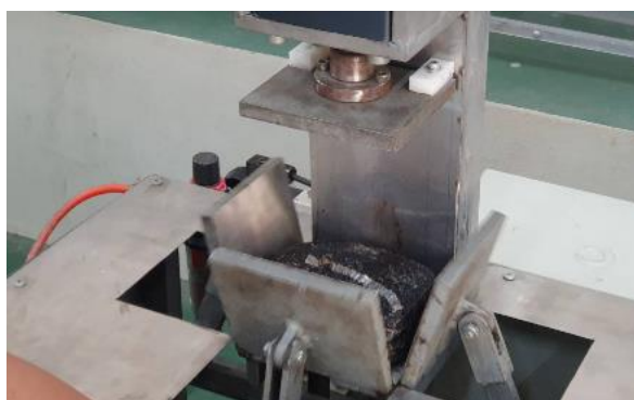
ขั้นตอนที่ 6 : รอให้เครื่องจักรอัดมะขามเปรี้ยวให้เป็นก้อน อาจทำการอัดมากกว่า 1 ครั้ง
