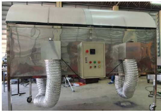
รูปที่ 4-3 ระบบการควบคุมพัดลมระบายอากาศและแผงควบคุมความร้อนแบบควบคุมป้อนกลับ
