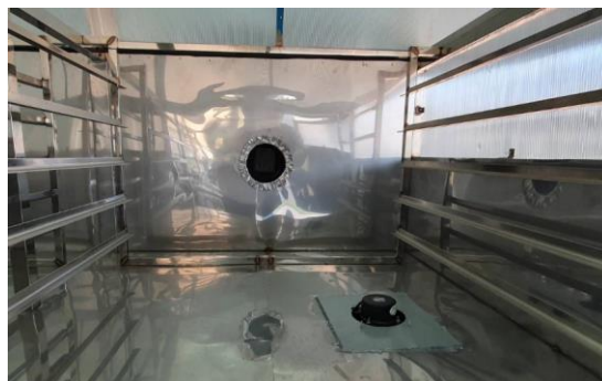
รูปที่ 4-4 แผงกระจายอุณหภูมิและพัดลมระบายอากาศ
