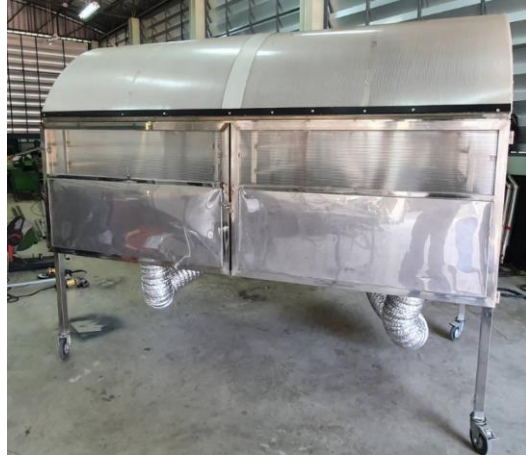
รูปที่ 4-2 ตู้บลมร้อนเมื่อดำเนินการเสร็จแล้ว
