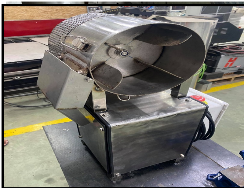
ภาพที่ ก-2 แสดงภาพถ่ายเครื่องหั่นแก่นตะวัน ภาพด้านใน
