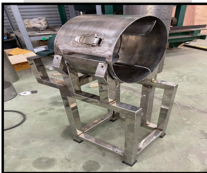
ภาพที่ 4-2 แสดงแบบโครงเครื่องฝานแก่นตะวัน
