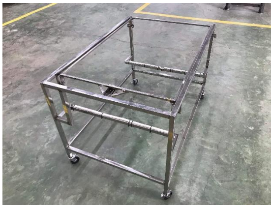
รูปที่ 4.4 โครงชุดอุปกรณ์ลำเลียงแผ่นกล้วยทอดในกระบวนการผลิตกล้วยอบไส้มะขาม
