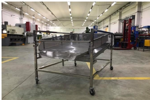
รูปที่ 4.2 ชุดอุปกรณ์ลำเลียงแผ่นกล้วยทอดในกระบวนการผลิตกล้วยอบไส้มะขาม
