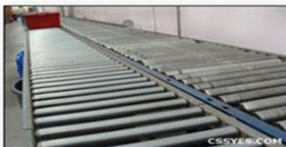
รูปที่ 2.14 รวงเลื่อนชนิดลูกกลิ้ง (Roller Conveyor)
