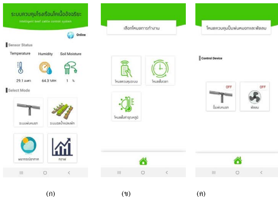
รูปที่ 3-18 (ก) หน้าจอหลักของระบบควบคุมโรงเรือน (ข) หน้าจอสำหรับเลือกโหมดการทำงานของระบบควบคุมโรงเรือน (ค) หน้าจอโหมดควบคุมการทำงานแบบแมนนวล
