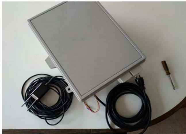
รูปที่ 3-40 ตู้ควบคุมอุปกรณ์ระบบให้น้ำแปลงหญ้าแบบอัตโนมัติพร้อมเซนเซอร์
