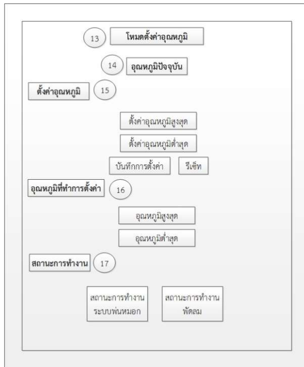
รูปที่ 3-15 การออกแบบหน้าจอบริการควบคุมโรงเรือนโหมคควบคุมการทำงานแบบตั้งอุณหภูมิ
