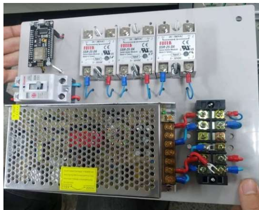
รูปที่ 3-29 การเชื่อมต่อแผงวงจรของระบบควบคุมโรงเรือนเลี้ยงโคเนื้อ
