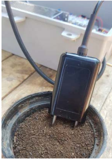
รูปที่ 3-44 ทดสอบเซนเซอร์วัดค่าความชื้นในดิน
