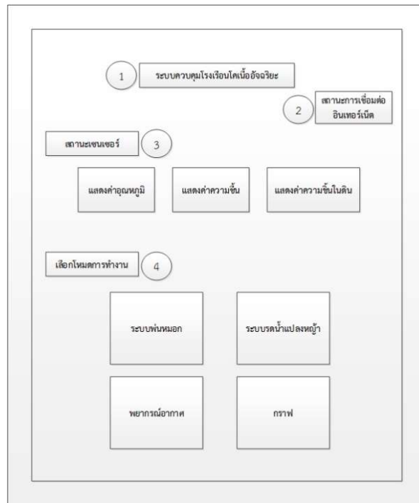
รูปที่ 3-11 การออกแบบหน้าจอแอปพลิเคชันของระบบควบคุมโรงเรือนเลี้ยงโคเนื้อ
