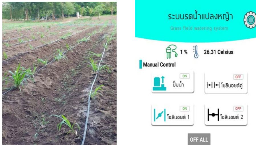
รูปที่ 4-6 ระบบให้น้ำแปลงหญ้าทำงานในโหมดควบคุมแบบแมนนวล
