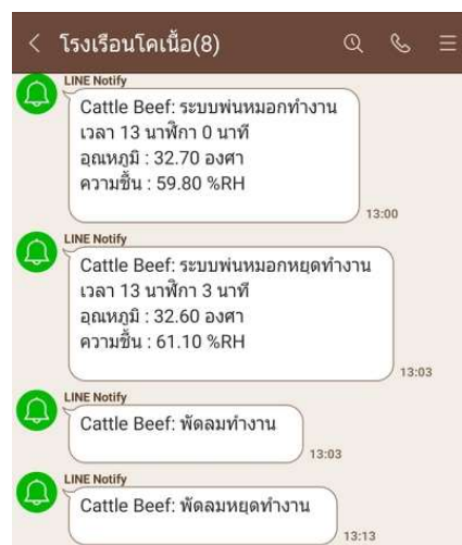
รูปที่ 4-4 ระบบพ่นหมอกและพัดลมทำงานตามกำหนดเวลาในโหมคตั้งเวลาทำงาน
