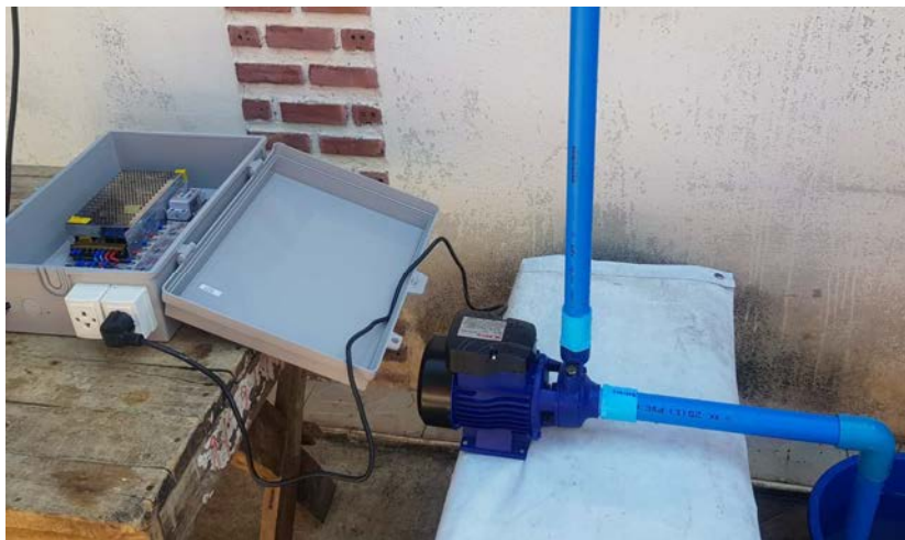
รูปที่ 3-45 ทดสอบการทำงานของระบบควบคุมการให้น้ำเพื่อส่งงานปั้มน้ำ
