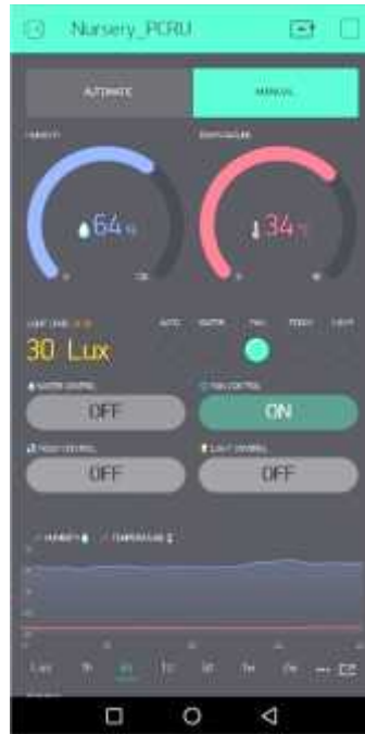
รูปที่ 3-17 แอปพลิเคชันแสดงสถานการณ์ทำงานแบบแมนนวลสั่งเปิดพัดลม
