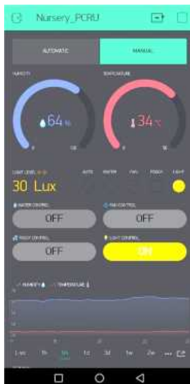
รูปที่ 3-19 แอปพลิเคชันแสดงสถานะการทำงานแบบแมนนวลสั่งเปิดไฟ
