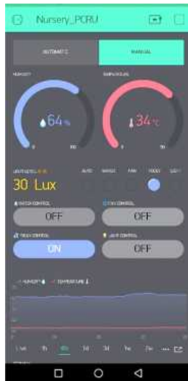
รูปที่ 3-18 แอปพลิเคชันแสดงสถานะการทำงานแบบแมนนวลสั่งเปิดระบบพ่นหมอก
