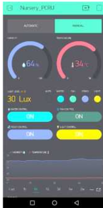
รูปที่ 3-20 แอปพลิเคชันแสดงสถานการณ์ทำงานแบบแมนนวลสั่งเปิดทุกระบบ
