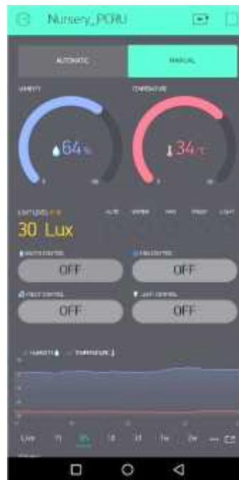
รูปที่ 3-15 แอปพลิเคชันแสดงสถานการณ์ทำงานแบบแมนนวล
