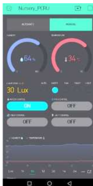
รูปที่ 3-16 แอปพลิเคชันแสดงสถานะการทำงานแบบแมนนวลสั่งรดน้ำ
