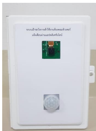
รูปที่ 3-12 กล่องใส่ PIR SANSOR และกล้องจับภาพ Pi Camera
