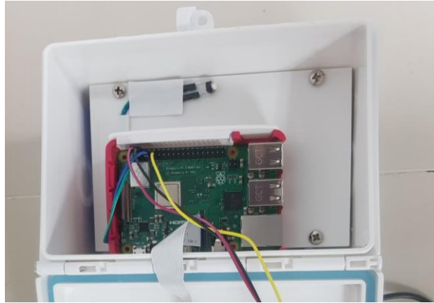
รูปที่ 3-13 การบอร์ดราสเบอร์รี่พายึดเข้ากับกล่อง
