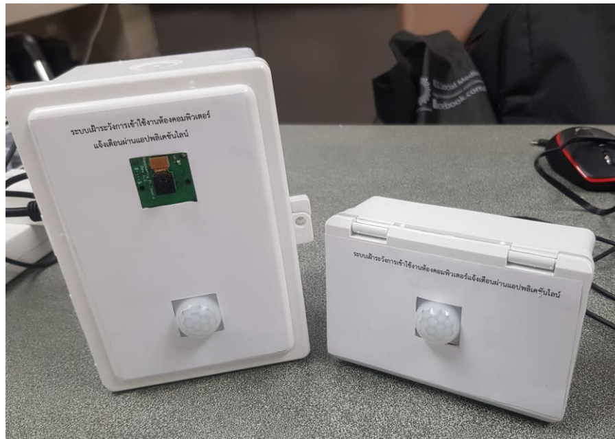
รูปที่ 3-19 ชุดอุปกรณ์ของระบบเฝ้าระวังการเข้าใช้งานห้องคอมพิวเตอร์แจ้งเตือนผ่านไลน์
