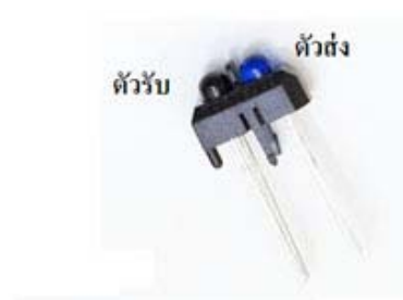
(ก) โครงสร้างภายในเซนเซอร์ชนิดใช้แสง (ข) ตัวอย่างอุปกรณ์เซนเซอร์ชนิดใช้แสง
