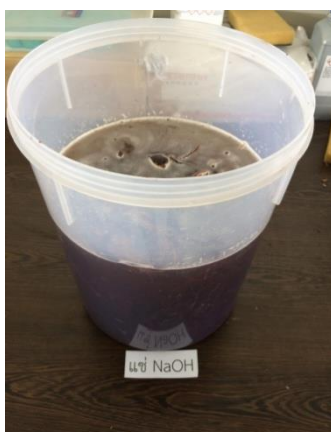
รูปที่ 3-11 แช่เส้นใยมะขามด้วยโซเดียมไฮดรอกไซด์ (ภาพถ่าย)
