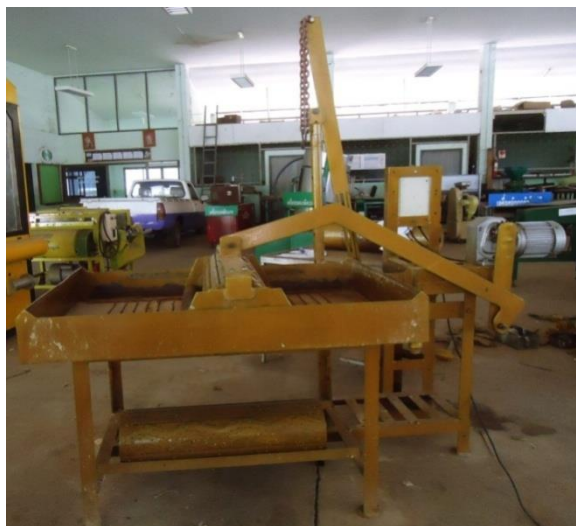
รูปที่ 3-12 เครื่องนวดเส้นไม้ไผ่แบบกระบะสี่เหลี่ยม (ภาพถ่าย)
