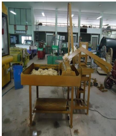
รูปที่ 3-2 เครื่องนวดไม้ไผ่แบบกระบะสี่เหลี่ยม (ภาพถ่าย)
