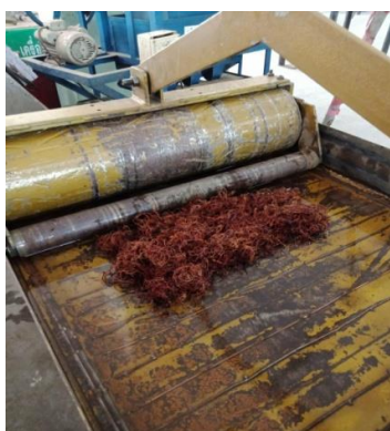
รูปที่ 3-13 นวดเส้นใยมะขามด้วยเครื่องนวดเส้นไม้ไผ่ (ภาพถ่าย)
