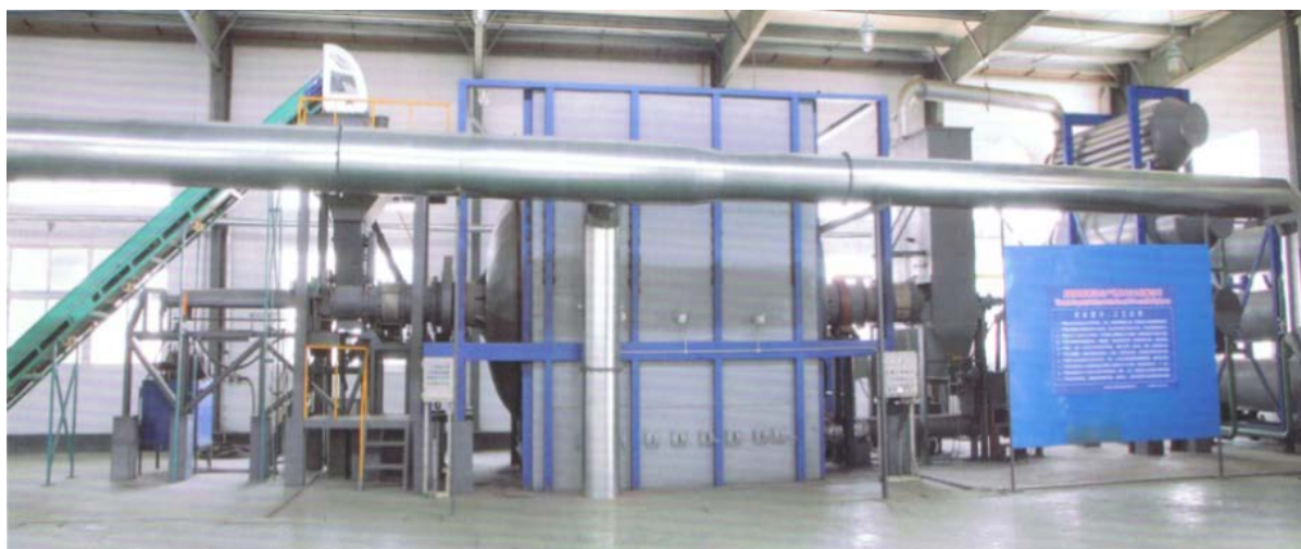
ภาพที่ 2.4 อุปกรณ์ไพโรไลซิสระบบอัตโนมัติ แหล่งที่มา : บริษัท มาชুকอน จำกัด (มหาชน), 2554: 30.
