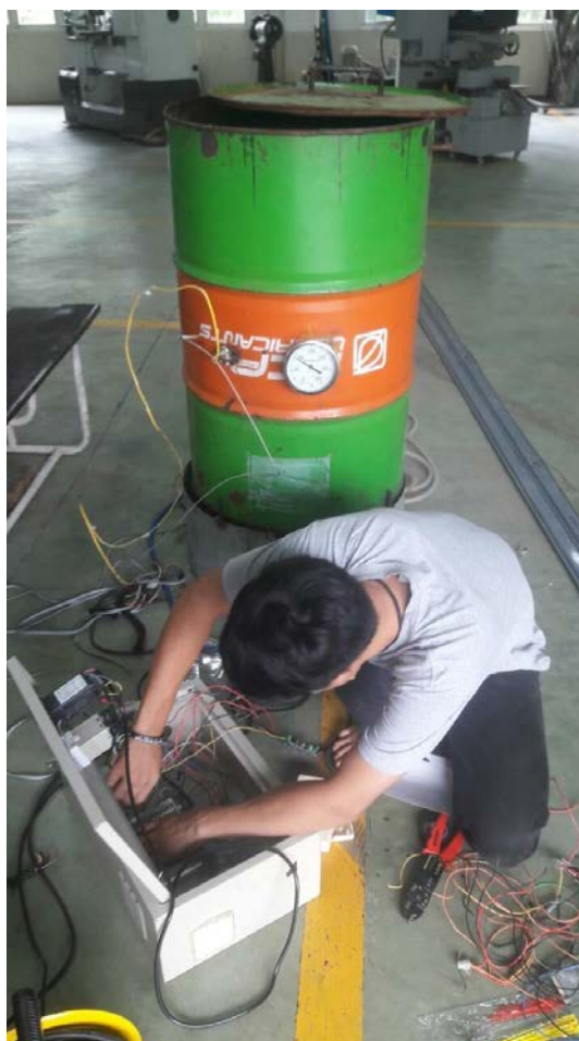
ภาพที่ จ.6 ติดตั้งอุปกรณ์ควบคุมการทำงานกับเตาอบความร้อนต้นทุนต่ำตามแนวเศรษฐกิจพอเพียง
