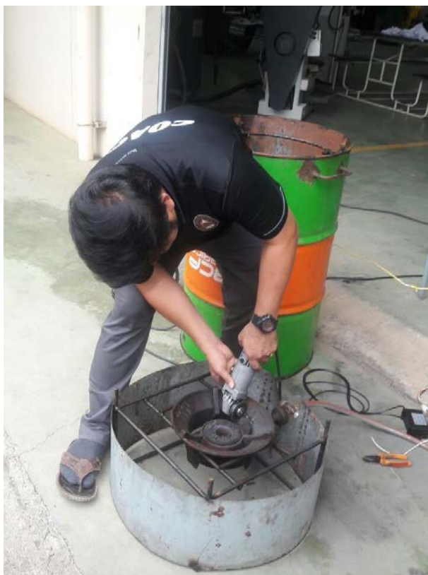
ภาพที่ จ.3 ปรับแต่งหัวเตาสำหรับติดตั้งตัวควบคุมการทำงานหัวเตา
