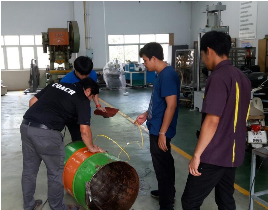
ภาพที่ จ.1 การออกแบบและเจาะถึงสำหรับติดตั้งเกจวัดอุณหภูมิ
