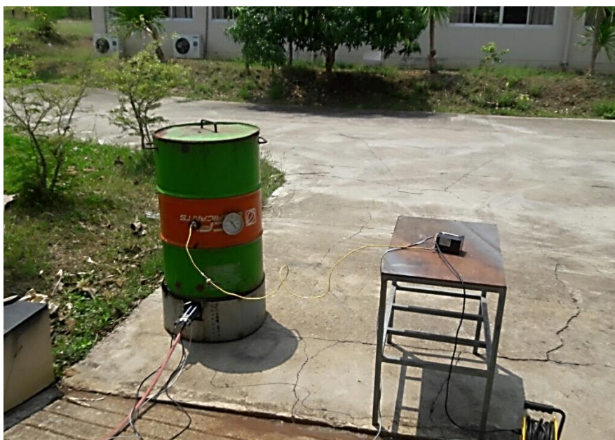
ภาพที่ จ.8 ทดสอบการทำงานของเตาอบความร้อนต้นทุนต่ำตามแนวเศรษฐกิจพอเพียง
