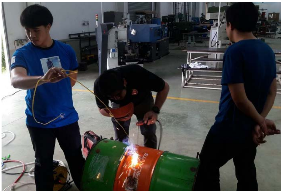
ภาพที่ จ.2 การเชื่อมตัวยึดเกจวัดอุณหภูมิ
