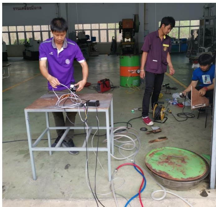
ภาพที่ จ.3 ปรับแต่งหัวเตาสำหรับติดตั้งตัวควบคุมการทำงานหัวเตา
